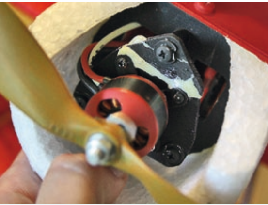
Der Holz-Motorspant an dieser Fokker Dr.1 wurde mit BELI-ZELL spaltfüllend dauerhaft repariert
